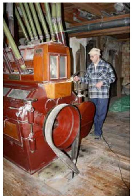
Samuel Stettler am Walzenstuhl (Marke Daverio, 1937). Der Stuhl verfügt über zwei Walzenpaare von 1000 mm Länge und 250 mm Durchmesser. Auf einer Seite sind vier Schrot- und eine Kopfpassage, auf der anderen Seite vier Auflöse- und Ausmahlpassagen angeordnet.
